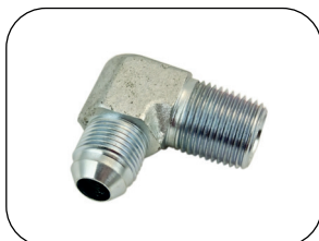
ADAPTADOR PARA MANGUEIRA 90° 7/16" JIC(M) x 1/4" NPT(M)
