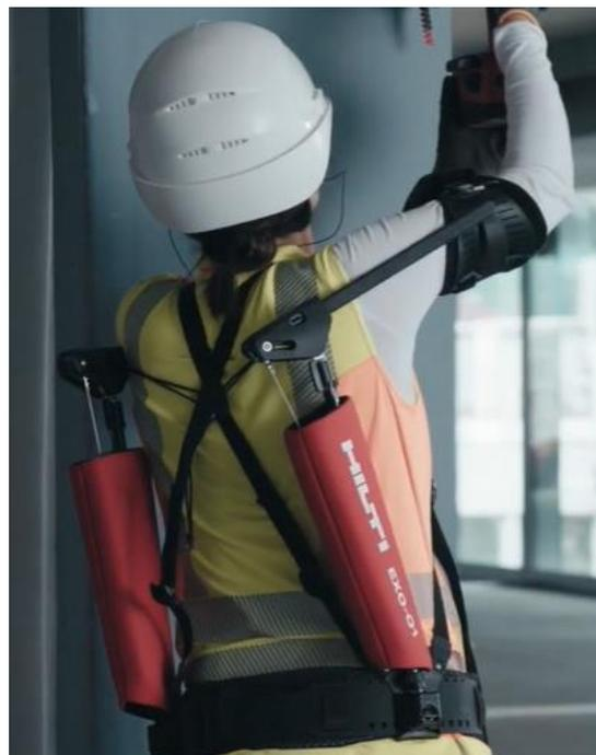
O exoesqueleto é um produto altamente recomendado para a segurança e ergonomia de usuários, especialmente trabalhadores que realizam trabalhos contínuos acima do nível da cabeça. O produto reduz a dor muscular e fadiga através do seu sistema de suporte de peso e oferece conforto para ser usado durante todo o dia sem limitar os movimentos do operador.
