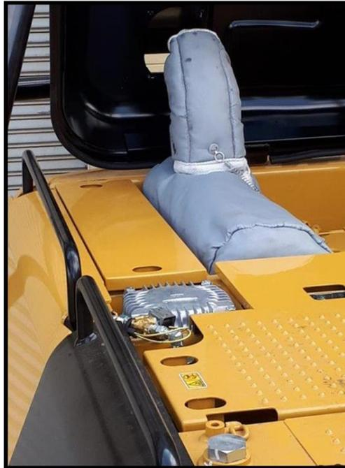
O maior índice de incêndios em equipamentos Off-Road, ocorre devido ao contato entre líquidos inflamáveis e regiões de alta temperatura.
